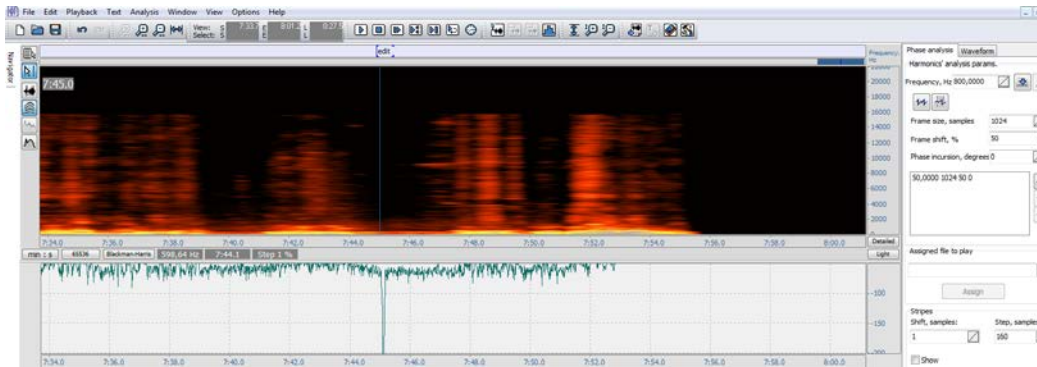
4.16 Espectrograma que muestra punto de edición entre 2 frases (minuto 7.39), fuerte atenuación de la amplitud armónica de la señal
